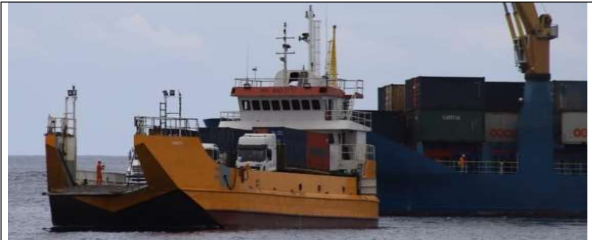
Descarga de contenedores mediante gabarra en el muelle del canal de Itabaca
