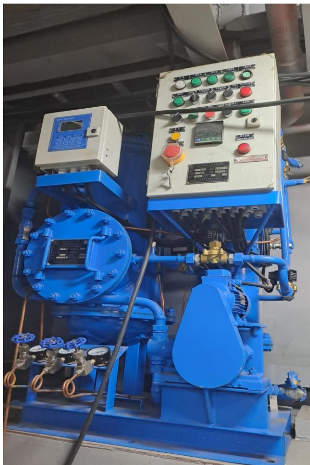
Fotografía 9. Sistema de tratamiento de aguas de sentina a bordo del ANGELITO II
