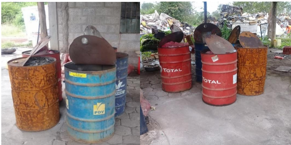
Fotografía 33. Almacenamiento temporal de cenizas resultantes del tratamiento de desechos sanitarios
