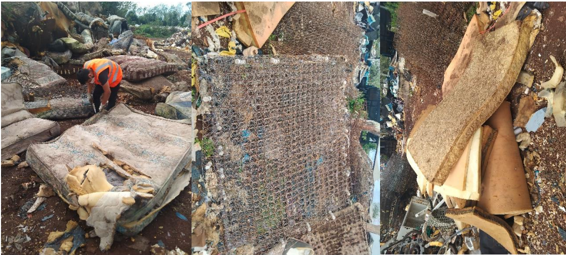
Fotografía 14. Separación de materiales de colchones en desuso
