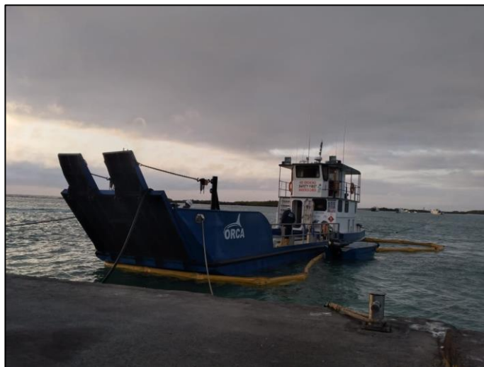
Fotografía No. 020: Barreras de contención.
