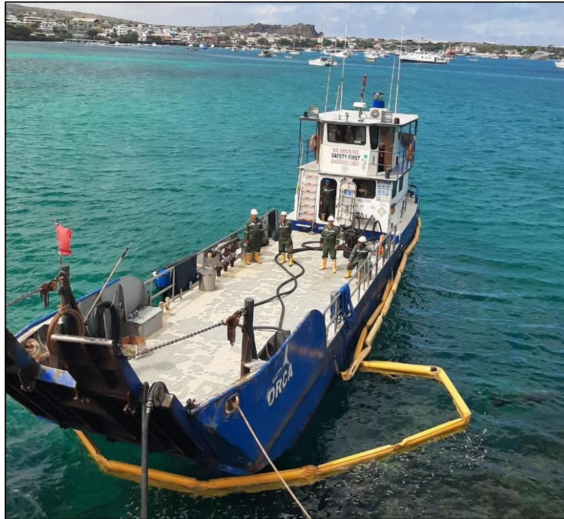
Fotografía No. 12: Uso de barreras de contención
