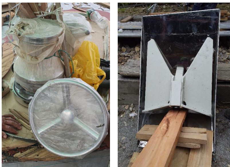
FOT. No. 15: Equipos del sistema de fondeo
