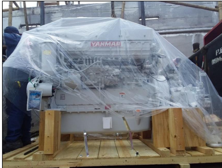
FOT. No. 9: Motores principales Yanmar 6HA2M-WDT
